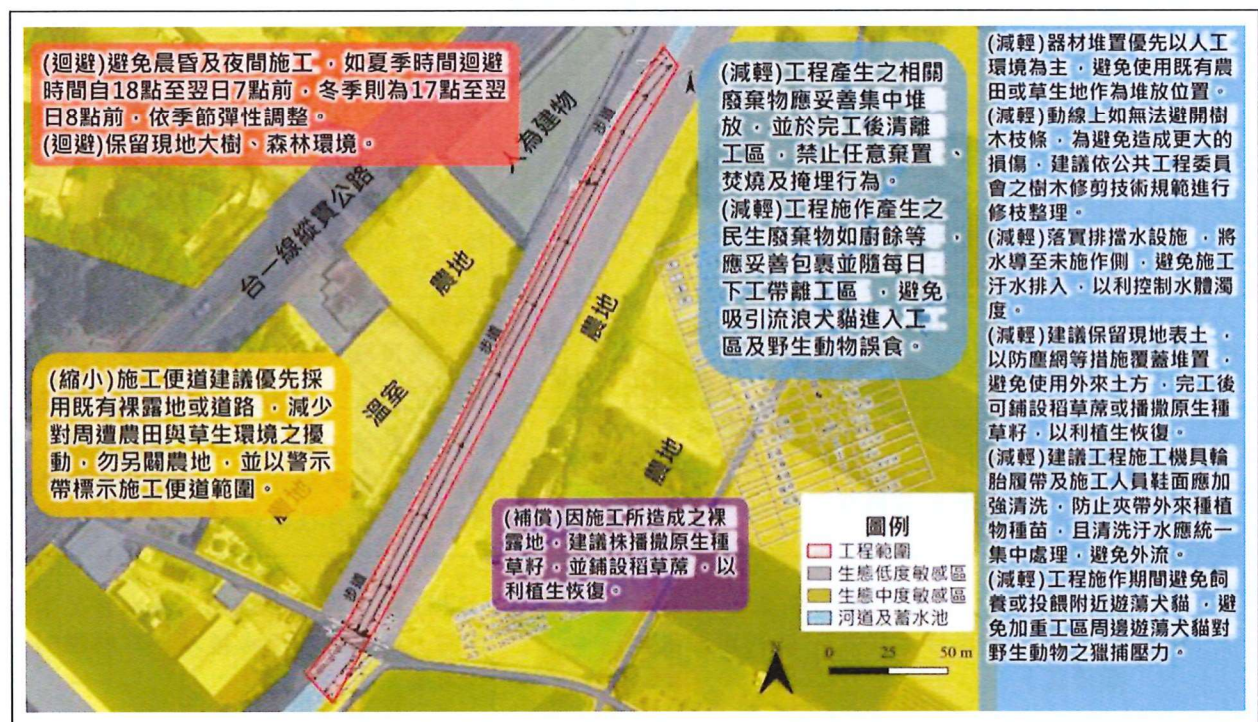
圖3-1、施工階段生態保育措施平面圖
